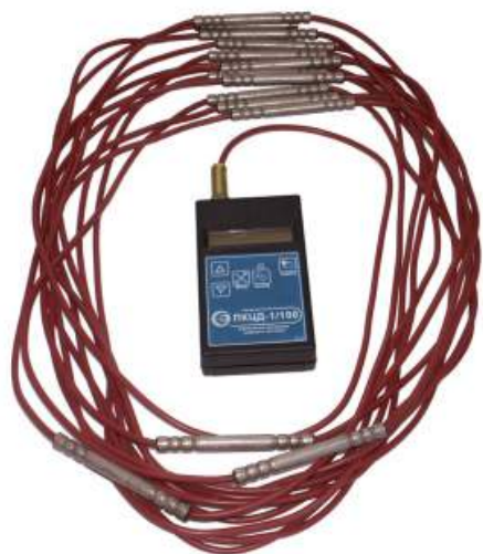
Рис. 1 – Термокоса (МЦДТ 0922) с контроллером (ПКЦД-1/100)
